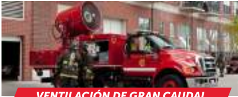
VENTILACIÓN DE GRAN CAUDAL
