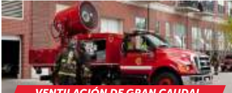
VENTILACIÓN DE GRAN CAUDAL
