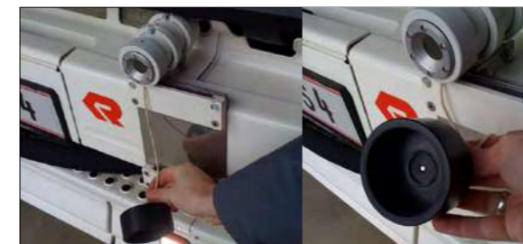
Tapa protectora contra gravas cuando la cámara térmica no está en uso
